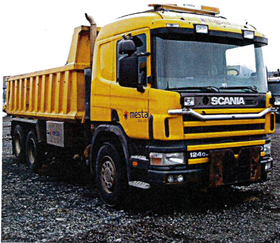
Scania P 124 GB lastebil 1997 modell, bygget etter spesifika- sjoner med hydraulikk- opplegg for spesialutstyr.
